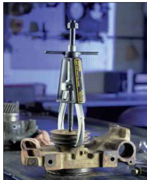
▲ Dwuramienny ściągacz EP-204 ustawiony do demontażu pompy wodnej.
