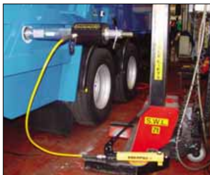
◀ Urządzenie RACH-306, napędzane pompą ręczną P-392, służy do wyciągania skorodowanych czopów karoseryjnych ze zezłomowanych samochodów.
