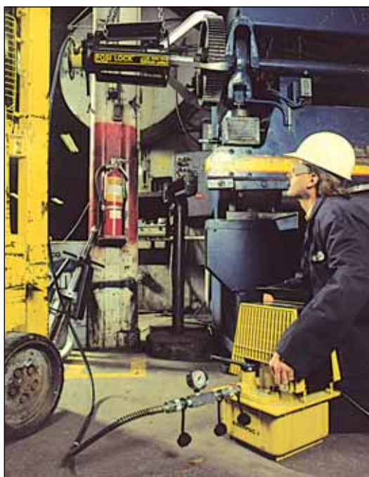
◀ Ściągacz EPHR-116 (50 ton) szybko i łatwo zdejmuje z wału przedstawione koło napędowe.
