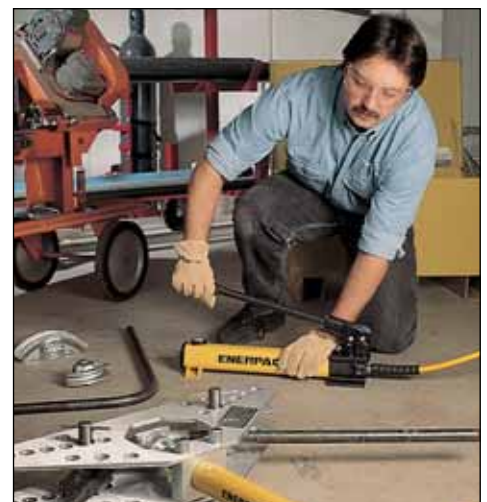
▲ Rura stalowa jest szybko i bezpiecznie wyginana pod kątem 90° z użyciem giętarki STB-101H.
