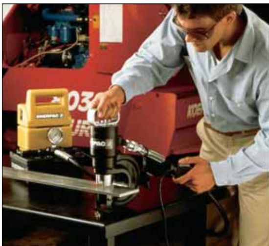
◀ Pompa PUD-1100E dostępna jest w zestawie dostosowanym do przebijaka 35-tonowego.
