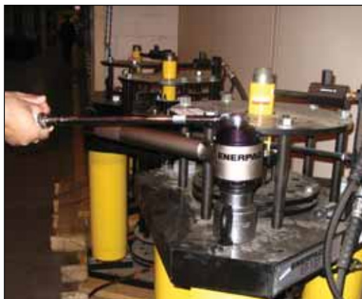
◀ Wzmacniacz momentu obrotowego z prętem reakcyjnym typu Enerpac E393 stosowany do śrub momentowych ręcznych do 4300 Nm.
